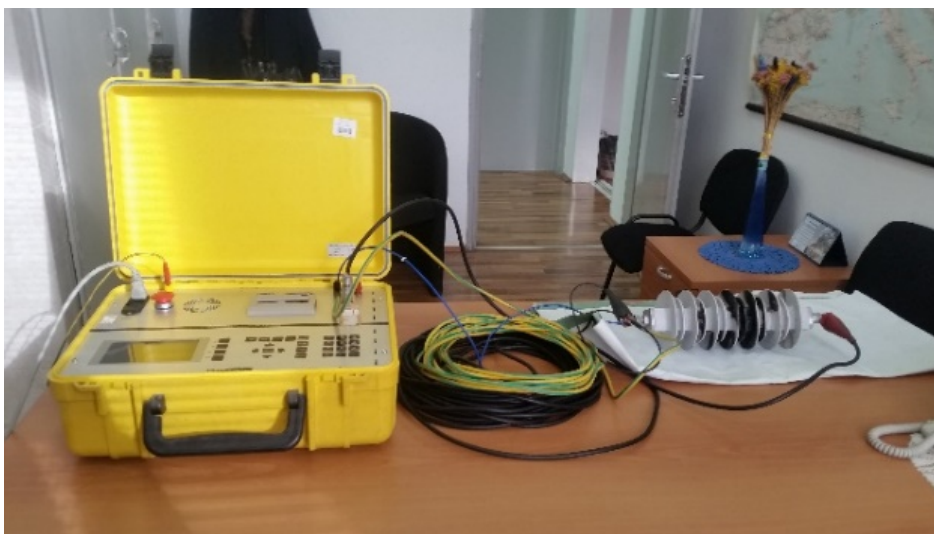
Slika 35. Eksperimentalna ispitivanja odvodnika prenapona primjenom RVM metode
